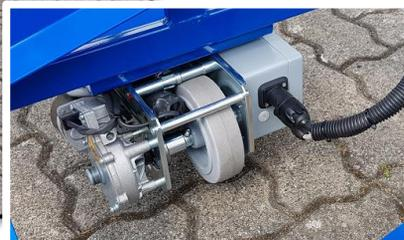
Der Antriebssystem kann als Nachrüstsatz an vorhandene Anhänger und Rollwagen angebracht werden.
